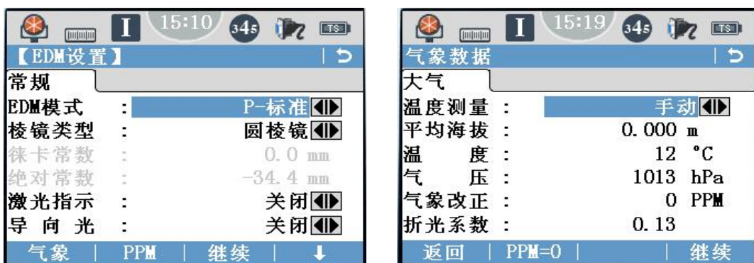
棱镜类型、棱镜常数、温度、气压设置
